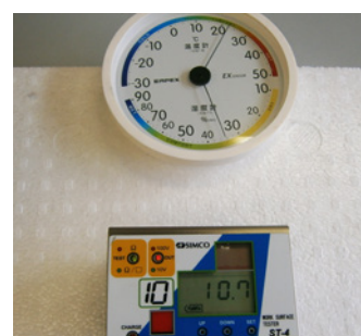
「BN-105」添加品を重ねて接触させると、内面の静電気が消滅するため樹脂粒が付着せず袋内で移動しやすい
